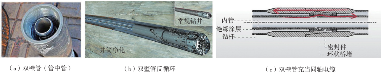
图 20 双壁管反循环钻井
