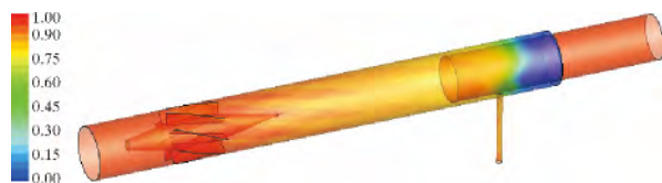
图 7 内联式脱液器内气相分布云图
